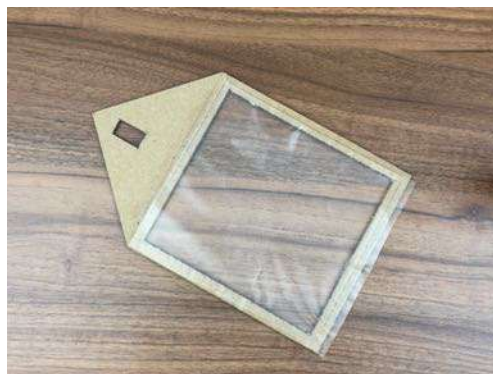
Obr. 13 – Nalepení fólie na stěny
