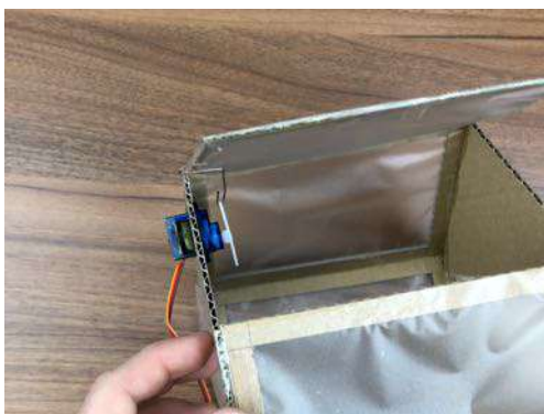
Obr. 16 – Spojení serva se střechou
